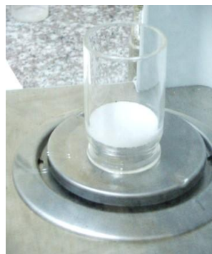
Fig. 208. Pesaje del crisol filtrante
