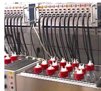
Fig. 235. Lectura producción de gases transductor
