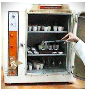
Fig. 219. Secamiento en estufa a 105° C.
