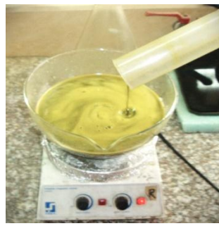
Fig. 229. Unión licor ruminal + Saliva artificial
