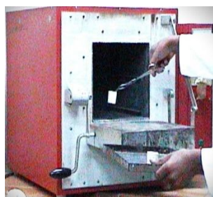
Fig. 204. Incineración en la mufla a 600° C.
