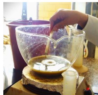
Fig. 227. Saturación con CO 2
