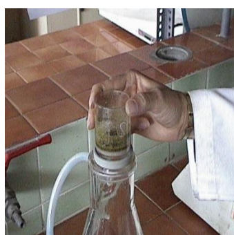
Fig. 214. Filtración y lavado digerido P+HCl
