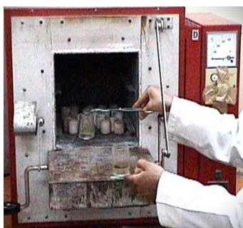
Fig. 222. Incineración en mufla a 600° C.
