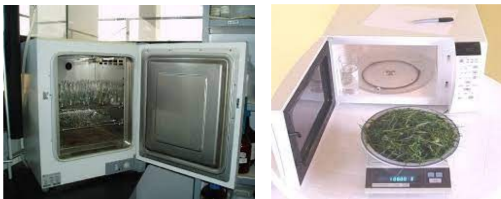
Figura 87. Equipos para la determinación de materia seca de muestra de forrajes para análisis bromatológico.
