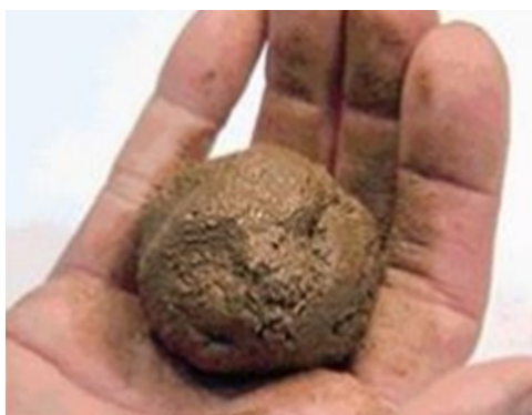
Gráfico 3-3: Determinación de la textura del suelo al tacto (bola de 2,5 cm).
