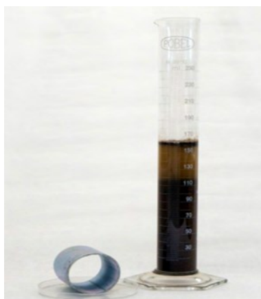
Gráfico 5-3: Método de hidrómetro de Bouyoucos
