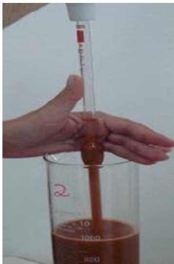
Gráfico 7-3: Análisis de tamaño de partícula con una pipeta.
