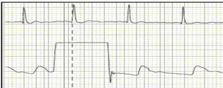
Figura 30 Evaluación de la frecuencia de resonancia del sistema
