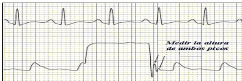
Figura 30 Evaluación de la frecuencia de resonancia del sistema
