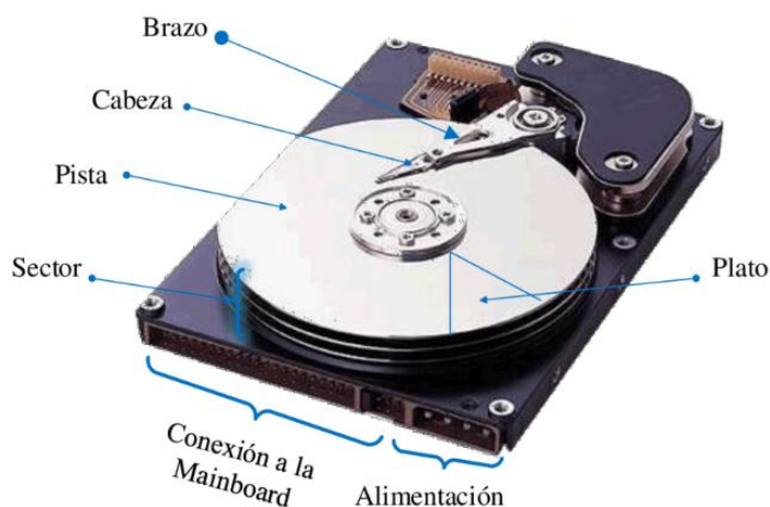
Figura 2.17 Componentes internos de un HDD.
