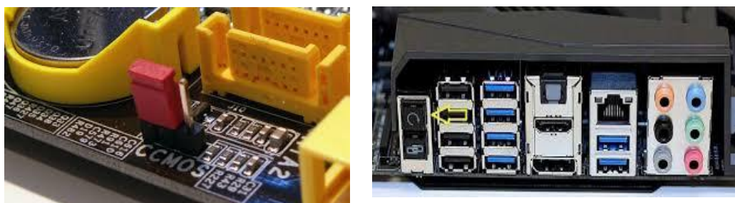
Figura 2.13 Formas de realizar el Clear CMOS
